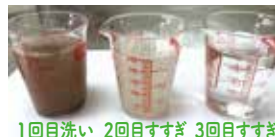
1回目洗い 2回目すすぎ 3回目すすぎ 洗浄により出た汚水。環境に配慮した中性洗剤を使用
